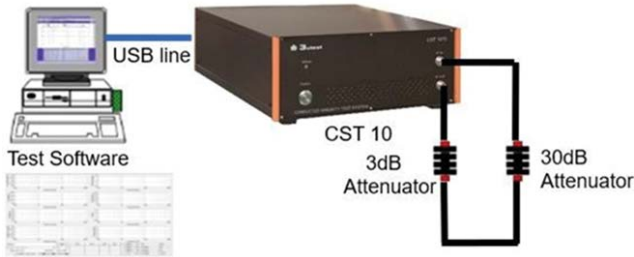
Схема калибровки для тестов по ISO 7637-4 Pulse A
