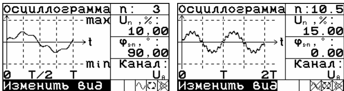
Рисунок 4.10. Окно «Форма сигнала» в варианте представления «Осциллограмма» (слева — режим интергармоник выключен, справа — режим интергармоник включен)
