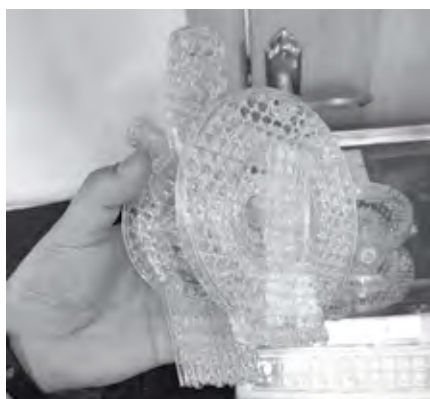
Рис. 8. Отмытый образец с поддержками
