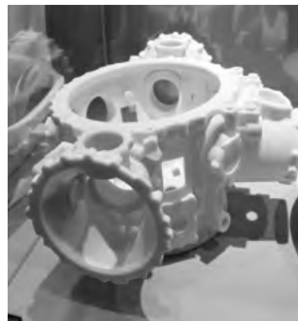
Рис. 4. Пример изделия, построенного по технологии SLS PS
