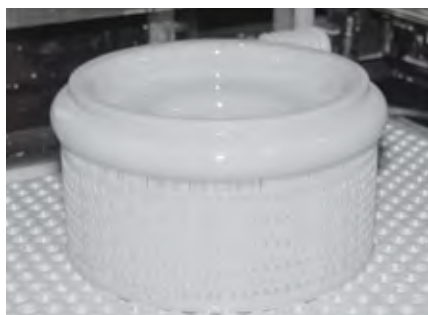
Рис. 2. Пример изделия, построенного по технологии DLP
