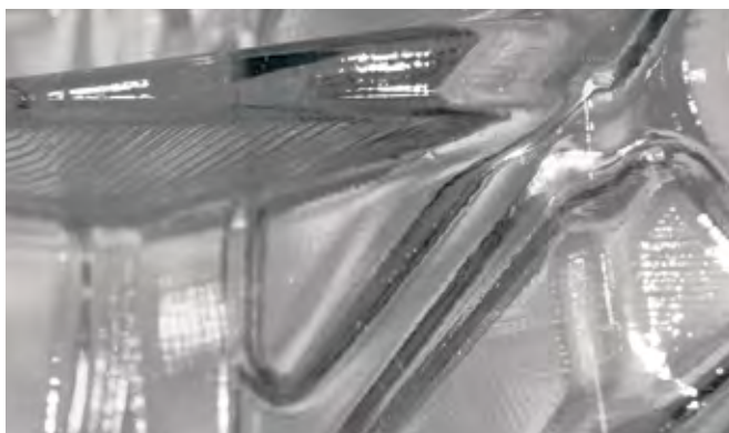
Рис. 5. Изделие из материала Somos WaterShed 11120
