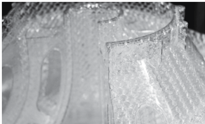
Рис. 1. Образец сетчатой структуры QC
