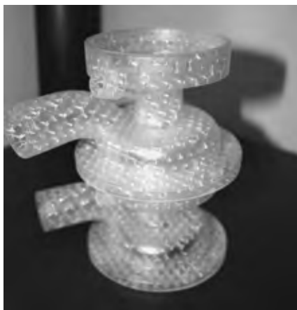
Рис. 7. Крышка насоса (QC) — два образца
