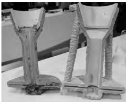
Рис. 18, 19. Оболочковая форма с высоким качеством поверхности
